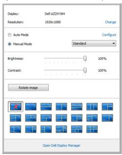
El cuadro de diálogo de configuración rápida también ofrece acceso a la interfaz avanzada de usuario de Dell Display Manager, la cual se utiliza para ajustar funciones básicas, configurar el Modo automático y acceder a otras funciones.
